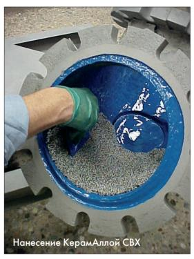
**МЕТАЛКЛАД КерамАллой СВХ** – это трехкомпонентный полимерный композит со 100% содержанием твердых веществ, после смешения приобретает консистенцию пасты, поэтому его легко наносить. При этом после отверждения СВХ превращается в твердую, как металл, структуру с высокой износоустойчивостью.
